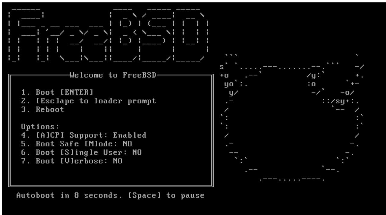
Σχήμα 1. Μενού Φορτωτή Εκκίνησης του FreeBSD
